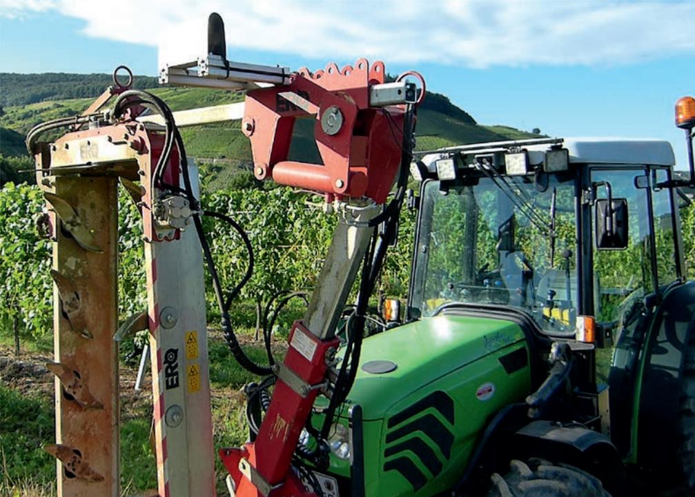
*Die Kamera wurden extra so weit nach vorne gezogen, dass sie sich vor dem umlaufenden Messer befinden. Über ihnen ist ein Schutzblech angebracht, damit sie nicht durch wegfliegende Rebteile beschädigt oder verstellt werden können. Über zwei Monitore bzw. einen geteilten Monitor mit Splitscreen-Ansicht in der Traktorkabine kann der Fahrer den Weg zu beiden Seiten einsehen und sicher gehen, bei der Ausfahrt niemanden zu verletzen.*
