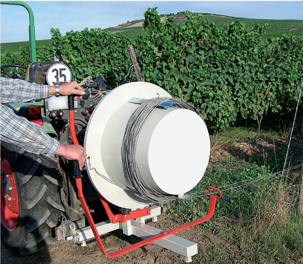
*Drahtwickelgerät mit Stellhebel zum Ein- und Ausrücken der Kupplung (Totmannschaltung)*
