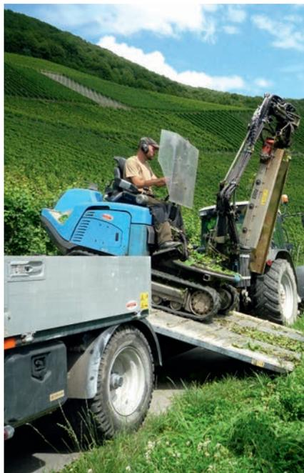
**Ausnahme:** RMS mit Hangelwinden dürfen auch in Weinberganlagen ohne Absturzsicherung an Weinbergmauern oder Steilböschungen eingesetzt werden, wenn bei Ausfall eines der beiden Sicherungssysteme (Fahrantrieb oder Hangelwinde) ein sicheres Anhalten möglich ist und die Gefährdungsbeurteilung ergeben hat, dass unter Berücksichtigung der besonderen Verhältnisse in der Weinberganlage (z. B. Geländeform, Breite des Vorgewendes, Tragfähigkeit des Bodens, Sichtverhältnisse)
