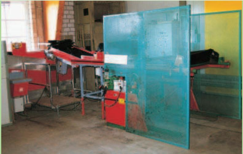
Jede stationär betriebene Maschine muss an jedem Arbeitsplatz mit einem Notausschalter ausgerüstet sein. An Sortiermaschinen haben sich Reißleinen bewährt. Sind verschiedene maschinelle Sortiereinrichtungen aneinandergeschaltet, müssen sie zusätzlich über einen zentralen Notausschalter verfügen, der bei Betätigung die Gesamtanlage stillsetzt.
