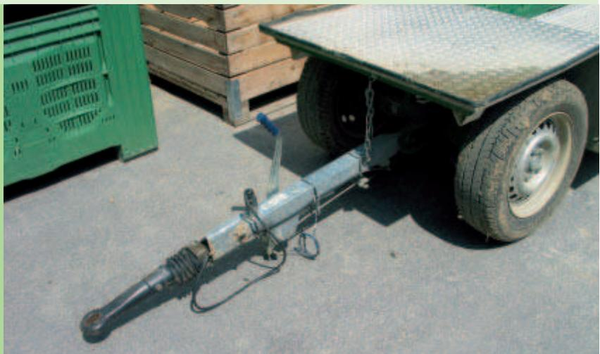
Auch Schlepper und Anhänger, die nur innerhalb des Betriebsgeländes – z.B. eingezäunte Obstplantagen – eingesetzt werden, müssen zumindest hinsichtlich der Sitze, Bremsen, Anhängelasten, Einrichtungen zum Verbinden von Fahrzeugen (einschl. Stützeinrichtungen) und Lenkeinrichtungen den Bestimmungen der StVZO entsprechen. Dies kann nur durch eine befähigte Person geprüft werden.
