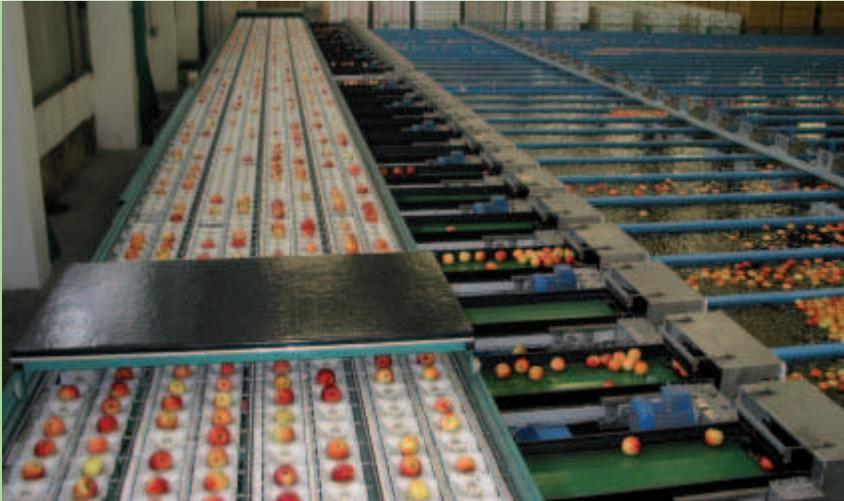
**siehe GBG 18** An Sortiermaschinen können funktionsbedingt vielfältige Gefahrstellen, wie z. B. Einzugs-, Quetsch- und Scherstellen auftreten. Diese sind durch sicherheitstechnische Einrichtungen, wie z. B. Verkleidung, Umwehung oder Abschrankung, zu beseitigen.
